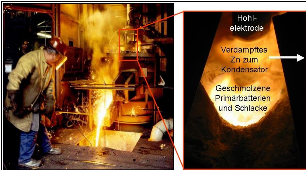
Abbildung 3: 500-kW-Gleichstrom-Elektrolichtbogenofen mit Hohlelektrode, IME, RWTH Aachen
