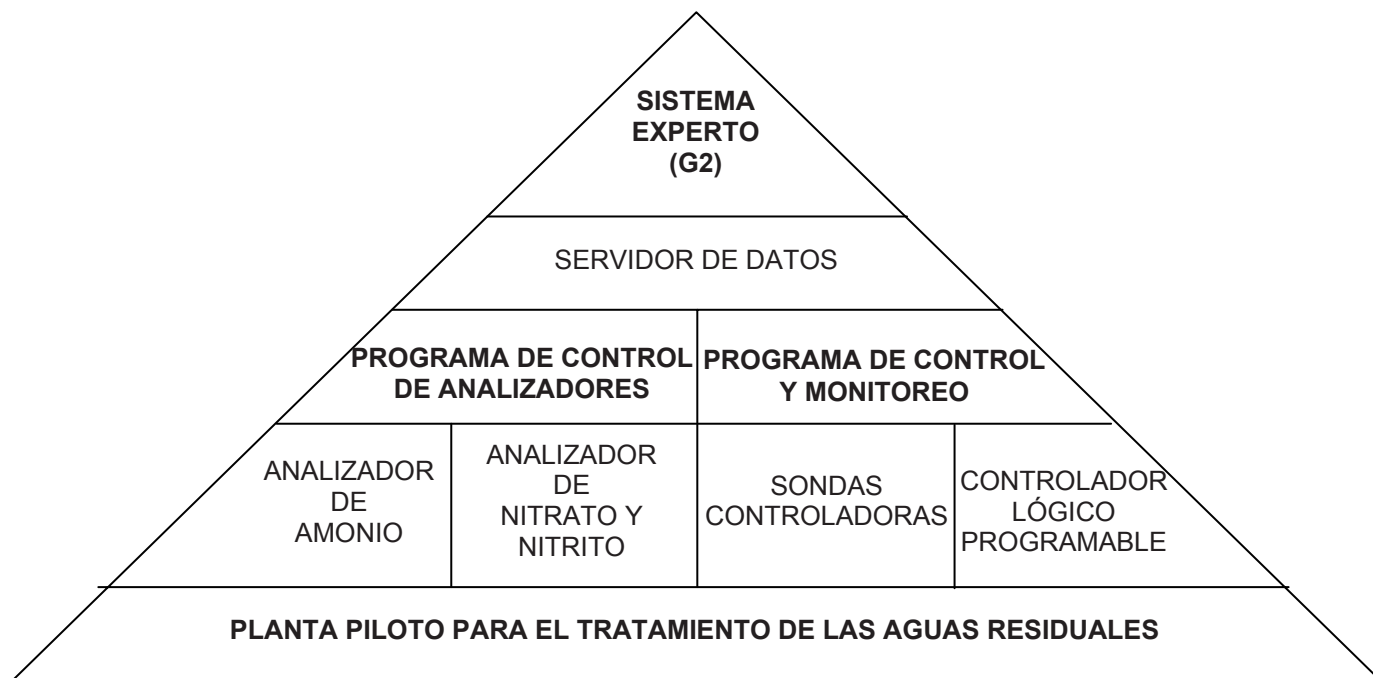
Fig. 4. Arquitectura del sistema de supervisión y control basado en conocimiento para PTARs.
