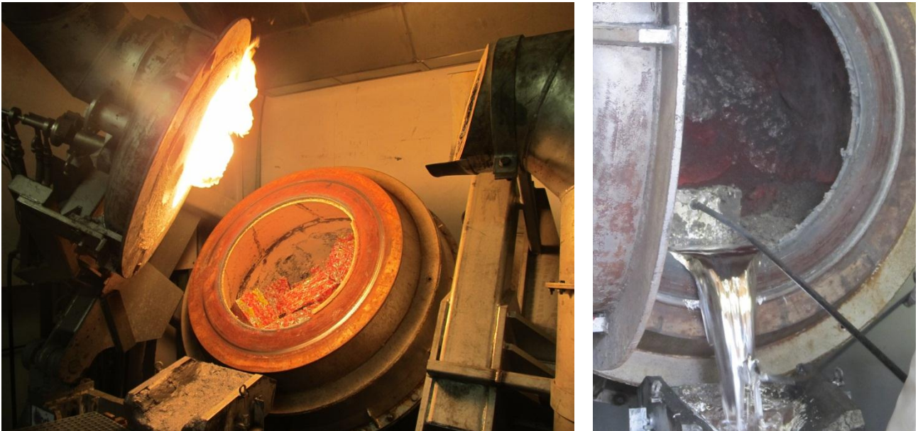
Abbildung 4: Demonstrations-TBRC am IME, Aachen; Chargieren von Dosenpaketen (links) und Aluminium Abguss (rechts)
