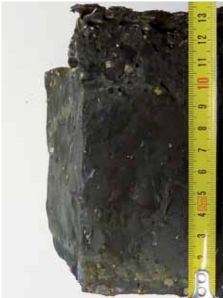
Bild 12: Querschnitt durch die Produktschlacke von der Kontaktfläche Metall (unten) bis zur Schlackenoberfläche (oben)
