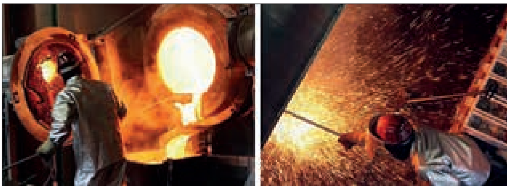
Abb. 3: Pyrometallurgische Verarbeitung von E-Schrott am IME
