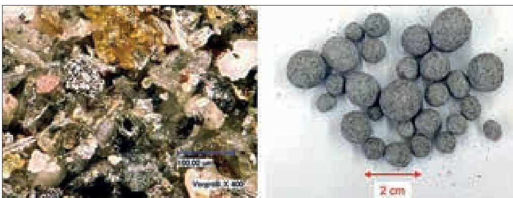
Abb. 4: Unklassierter Filterstaub unter 400-facher Vergrößerung und ge- trocknete Pellets auf Basis von Filterstaub
