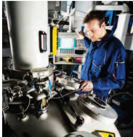
Abb. 1: Arbeiten am VSG 100 Vakuuminduktionsofen des IME
