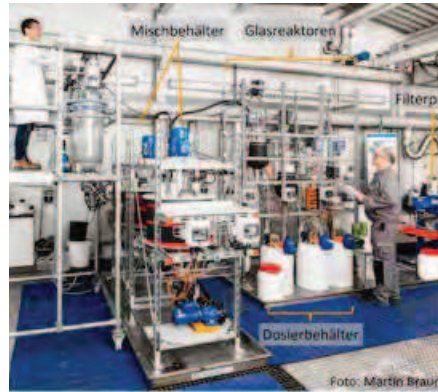
Abb. 4: Vollkontinuierliche Laugung der Seltenen Erden am IME
