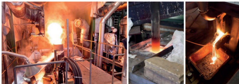
Bild 9: Betrieb des Technikum-Rührreaktors in Kombination mit dem Kippdrehtrommelofen
