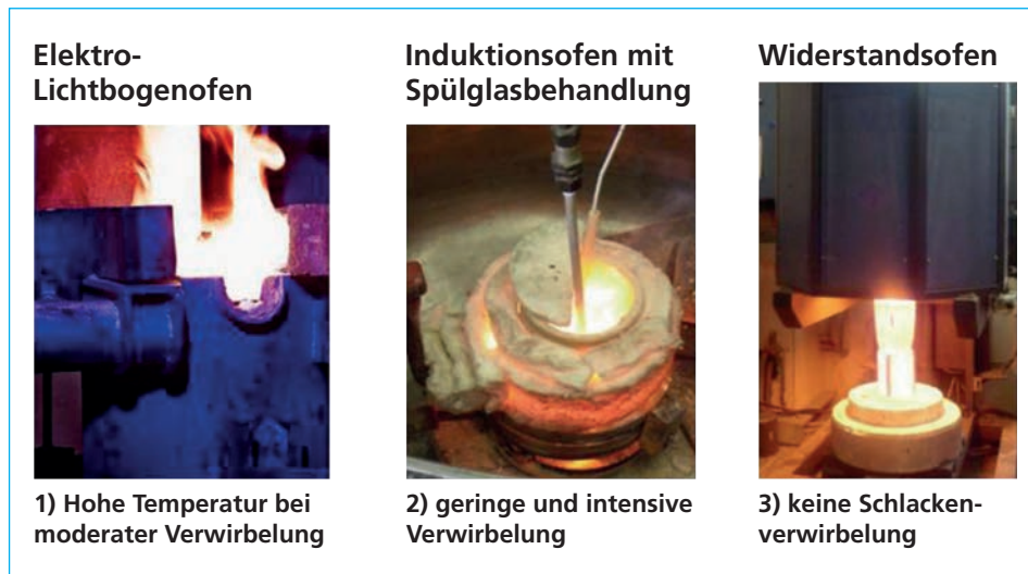
Bild 6: Eingesetzte Laboröfen am IME
