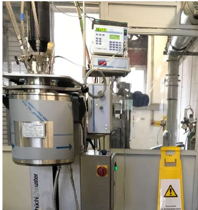
Figure 2 – Autoclave for the carbonation process Рис. 2 – Автоклава для процесса карбонизации Слика 2 – Аутоклава за везивање угљен-диоксида
